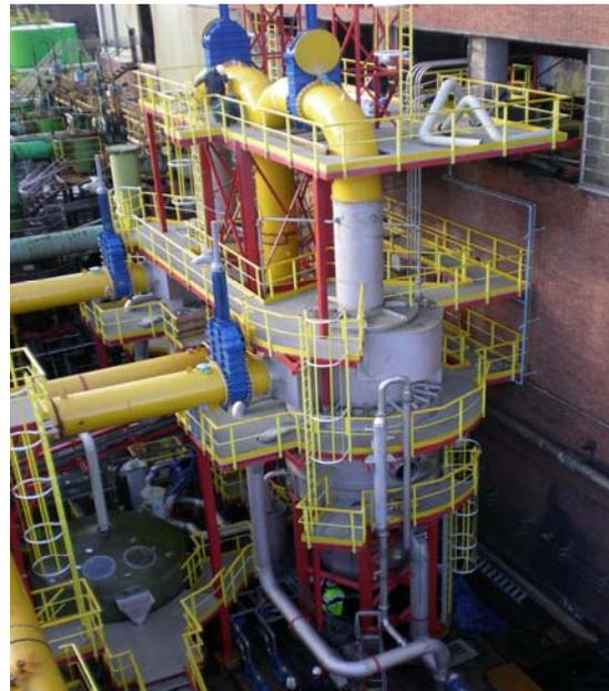
Bild 12: Darstellung der neuen Ammoniumsulfatanlage
