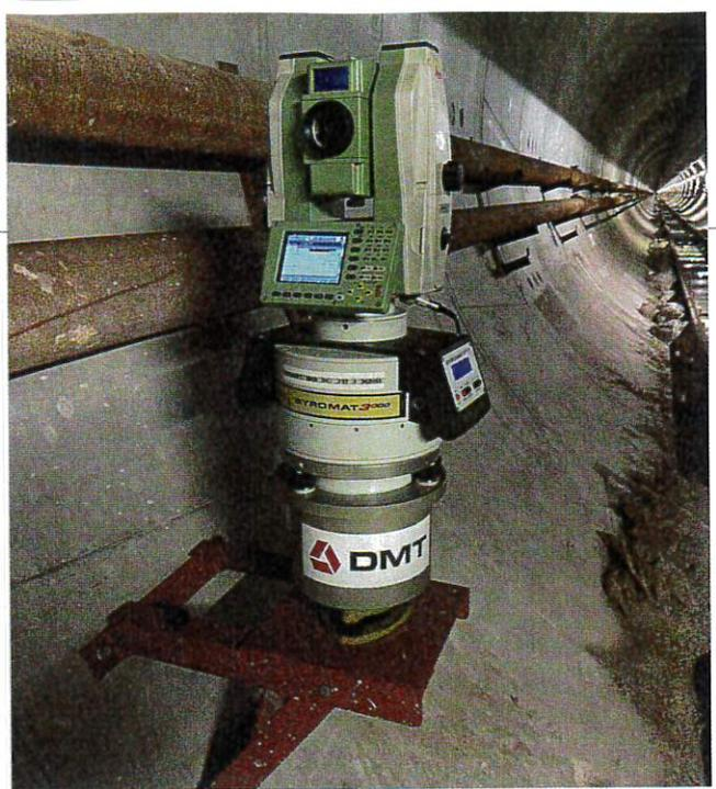
Bild 2: Der GYROMAT während der Messung im Musaimeer Outfall-Tunnel
