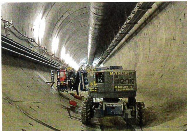
Bild 1: Während der Kreiselmessung im Storm Water-Tunnel auf einem „Cherrypicker“.
