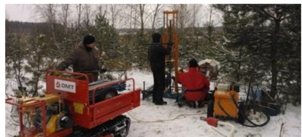
Drucksondierausrüstung im Einsatz
