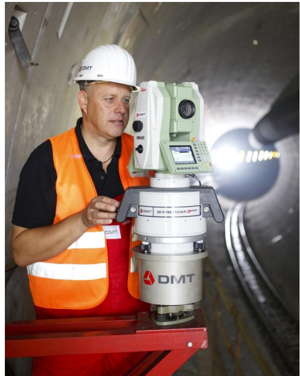
Kontrollmessung im Tunnel
