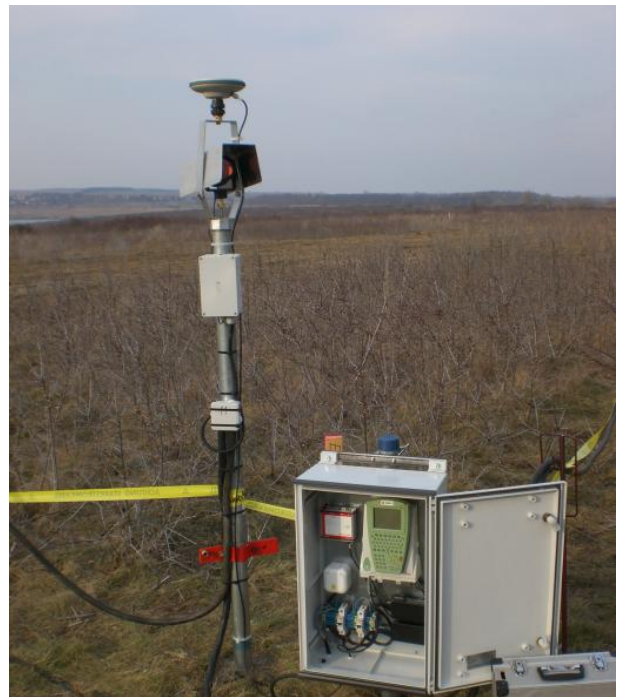
Objektpunkt - GNSS-Empfänger und Prisma
