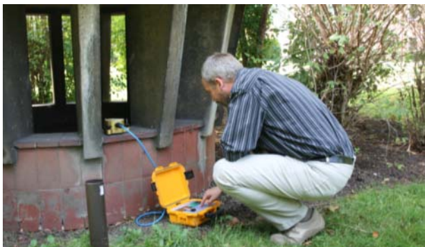
Erschütterungsmessung an einem Luftschaft
