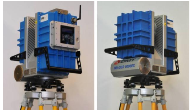
Explosionssgeschützter 3D Laserscanner IMAGER 5006 Ex
