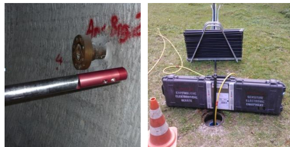
C-ALS Hohlraumscanner; links Sonde - rechts Bohrloch und über Tage Situation
