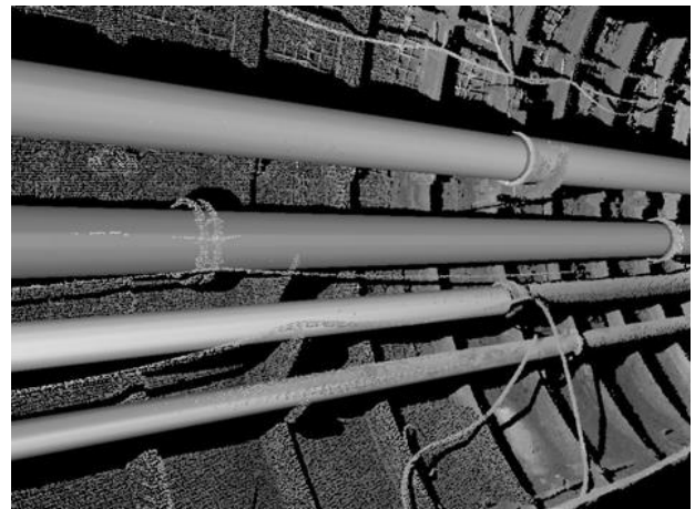
Modellierung für Einbauplanungen von Rohrleitungen
