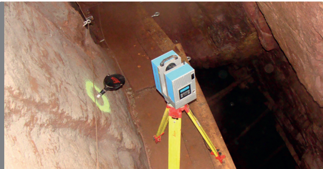
3D Laserscanner im Erzgang
