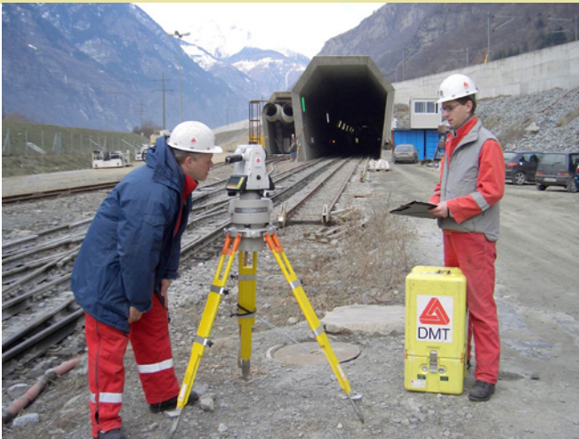
Bild 1: Mit-Autor Volker Schultheiß im Einsatz mit dem Gyromat 2000 vor dem Südportal des Tunnels in Bodio / Tessin
