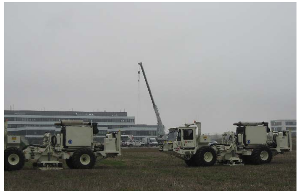
Vibratorfahrzeuge bei der VSP-Messung in Freiham
