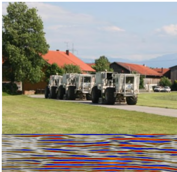
Messtrupp im Gelände und seismisches Profil
